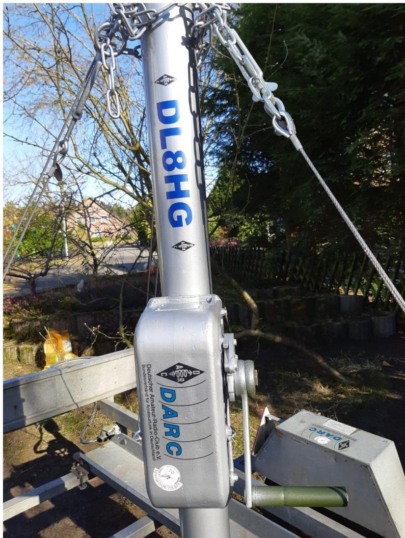
In die 26mm Aufnahme habe ich einen passenden Bolzen gesetzt, der seinerseits noch die Reste eines Antennenschiebemastes auf nimmt. So stehen mir nun insgesamt 6m Mast und knapp 4m Verlängerung zur Verfügung. Welche Antennenbestückung nun installiert wird....mal sehen, eine 2m Yagi denke ich und einen Dipol für die Kurzwelle, mal sehen. Ich freu mich darauf. Als TRX kommt mein Yaesu FT991 zum Einsatz.
