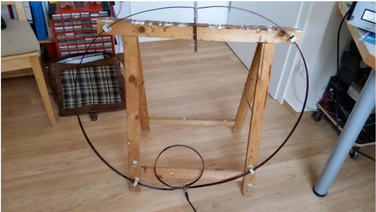
Aufbau der Antennen auf einem Holzbock aus dem Baumarkt, kann auch eine durchgehende Platte sein.
