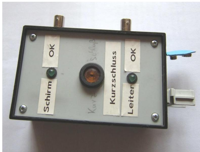
Dieser Tester findet Unterbrechungen, Kurzschlüsse und offenen Durchgang bei Gleichstrom.Fehler die sich auf HF-Signale auswirken können, findet er nicht.
